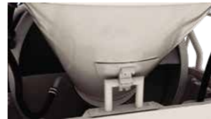
Vòi phun nước vào trong bồn trộn
